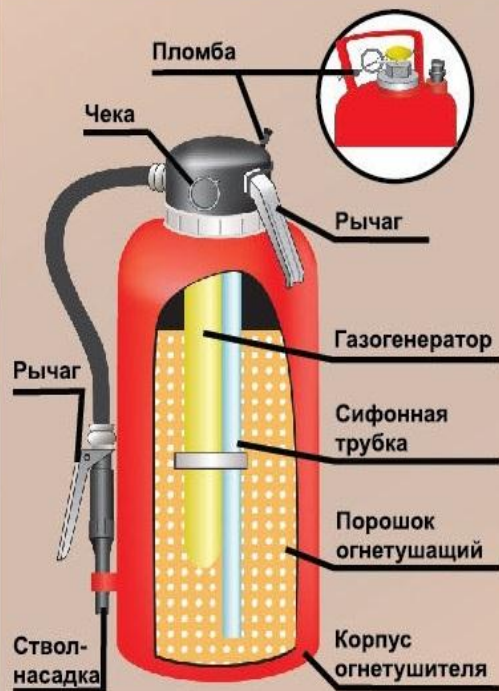
Огнетушитель со встроенным источником давления
